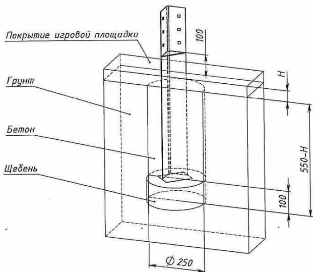
**Схема установки опоры
