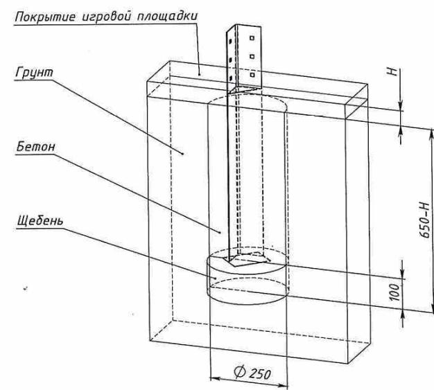
**Схема установки опоры
