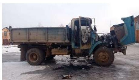
Пожаром уничтожена кабина автомобиля ЗИЛ; повреждено подкапотное пространство. Причиной пожара послужила неисправность систем, механизмов и узлов транспортного средства.
